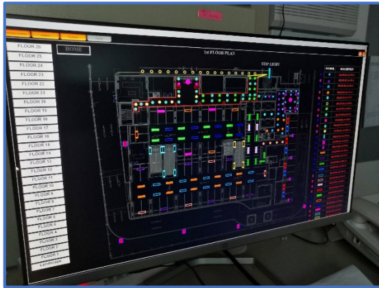
รูปที่ 20 ระบบควบคุมการเปิด-ปิดไฟ
